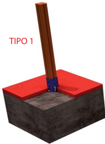
FIJACION A SOLERA DE HORMIGON
